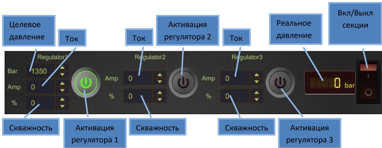
В данной секции находится управление регуляторами давления. Так же здесь отображается реальное давление в шине.
