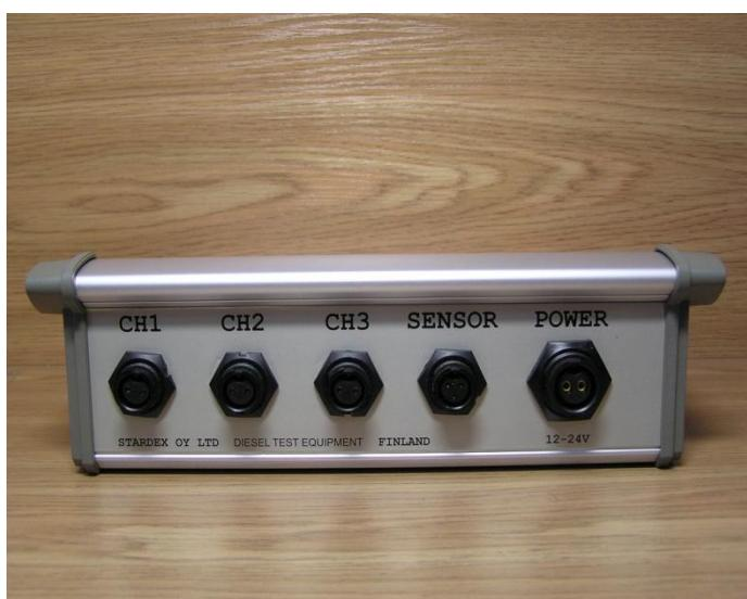
Разъемы на задней панели устройства:
