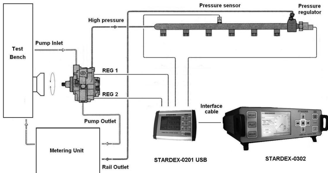
Примечание: при проверке некоторых насосов Bosch CP1, в которых установлен регулятор давления аналогичный регулятору давления, установленному в топливной
